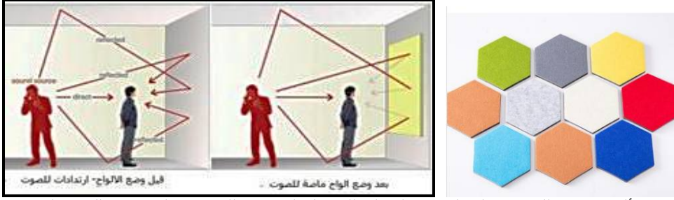
شكل رقم (19): تركيب ألواح ماصة للصوت على الحوائط الداخلية للفصول الملاصقة للفراغات الصاخبة يقلل من الشعور بالضوضاء مع مراعاة أن تكون مواد غير مكلفة وذات ملمس خشن وبألوان مبهجة (http://www.beardan.com)
